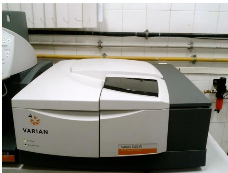
**Figura 11.** Espectrômetro no infravermelho VARIAN 640-IR
