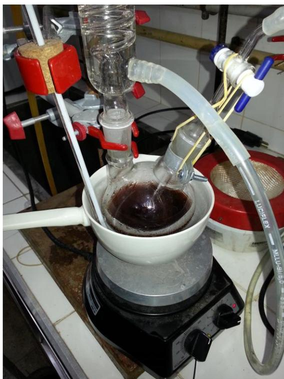
**Figura 10.** Aparelho para preparação da lignina dioxano.
