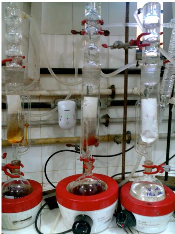
**Figura 9.** Extrator do tipo Soxhlet
