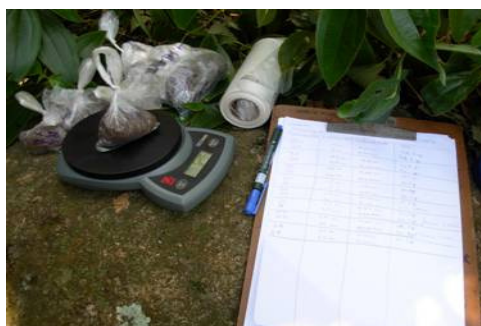
Figura 07: Material utilizado em campo para acondicionar, etiquetar e medir o peso úmido das amostras de solo
