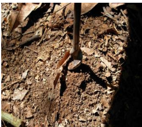
Figura 06: Coleta de solo com trado de rosca
