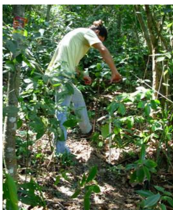
Figura 06: Coleta de solo com trado de rosca
