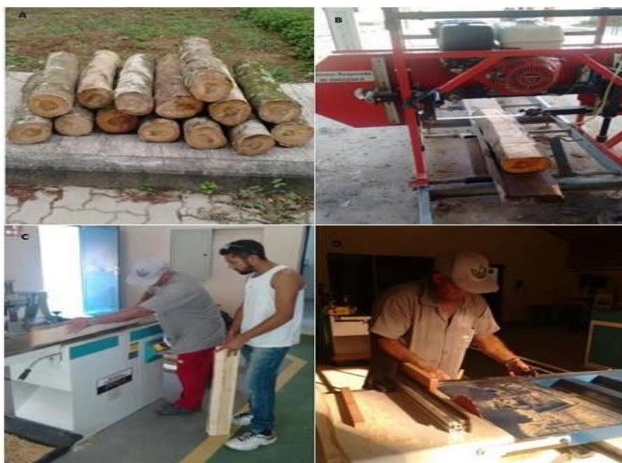
Figura 3: Obtenção dos toretes para o estudo e para confecção dos corpos-de prova. (A) Toretos selecionados, (B) desdobro dos toretes de aproximadamente 1,10m de comprimento, (C e D) confecção dos corpos-de- prova.
