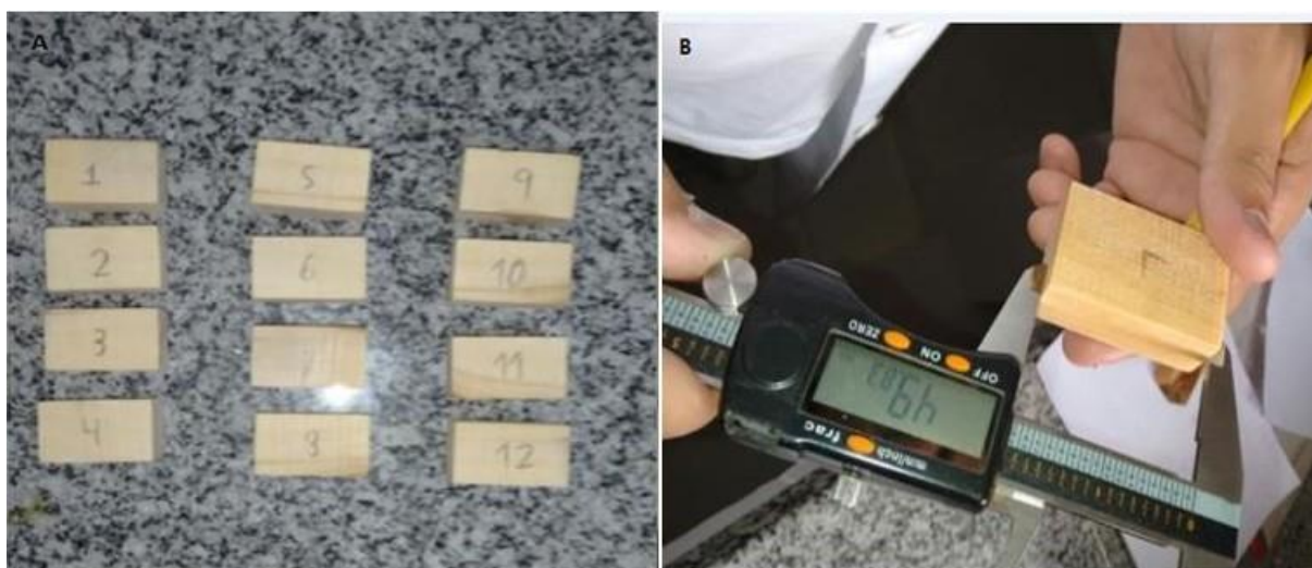
Figura 4: Corpos-de-prova utilizados na avaliação das propriedades físicas da madeira de leucena (A), paquímetro digital usado para determinação das dimensões das amostras (B).
