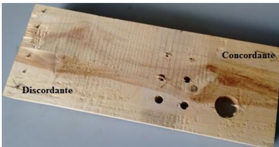
Figura 7: Defeitos característicos encontrados no teste de plaina no sentido concordante e discordante, sendo eles arrepiamento de grã, arrancamento de grã e marcas de cavaco.
