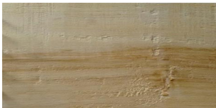
Figura 8: Amostra de madeira apresentando riscamento e grã felpuda após teste de lixa.
