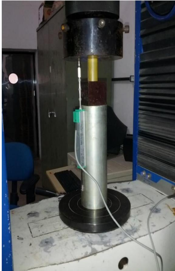
**Figura 146.** Ensaio de compressão paralela em um corpo de prova da espécie *Phyllostachys aurea* (Fonte: o autor, 2016).
