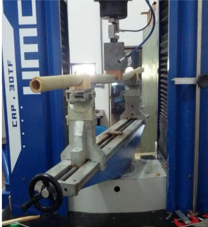
**Figura 14.** Ensaio de flexão estática a três pontos em um colmo de *Bambusa tuldooides* (Fonte: o autor, 2016).
