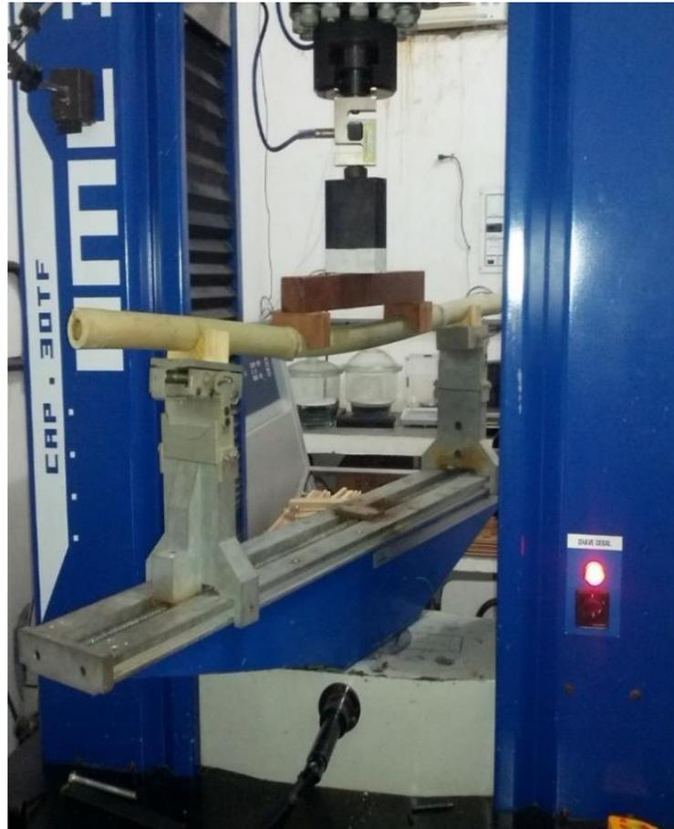
**Figura 15.** Ensaio de flexão estática a quatro pontos em um colmo de *Bambusa tuldoides* (Fonte: o autor, 2016).
