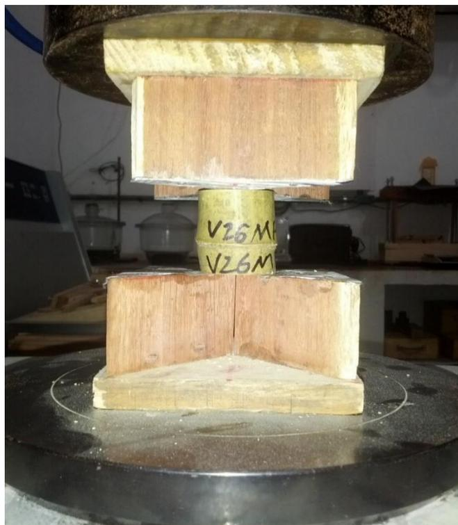
**Figura 160.** Ensaio de cisalhamento paralelo às fibras em um corpo de prova da espécie *Bambusa tuldooides* (Fonte: o autor, 2016).
