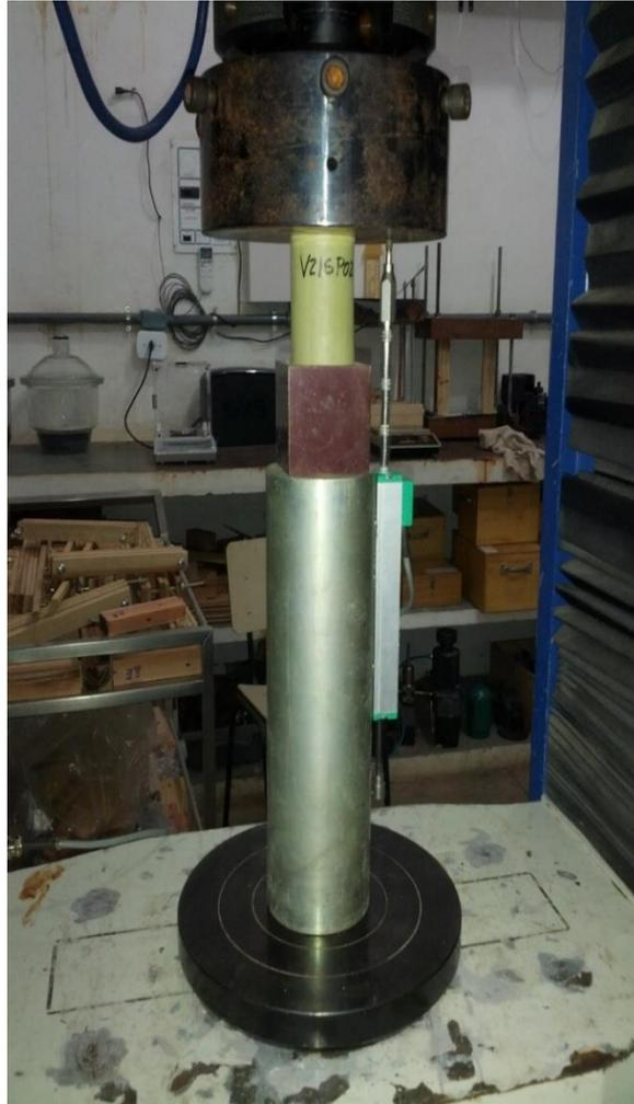
**Figura 17.** Ensaio de compressão paralela em um corpo de prova da espécie *Bambusa tuldooides* (Fonte: o autor, 2016).
