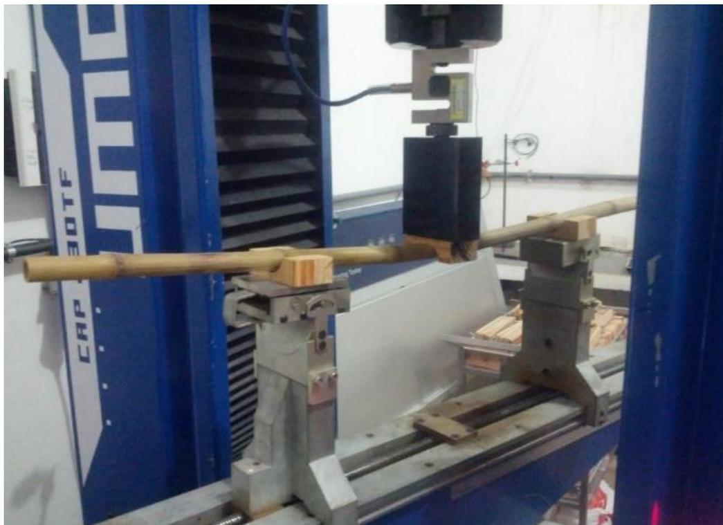
**Figura 13.** Ensaio de flexão estática a três pontos em um colmo de *Phyllostachys aurea* (Fonte: o autor, 2016).
