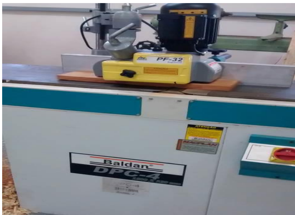
Figura 8- Plaina Baldan DPC-4 PF-32 utilizada nos testes de aplainamento.
