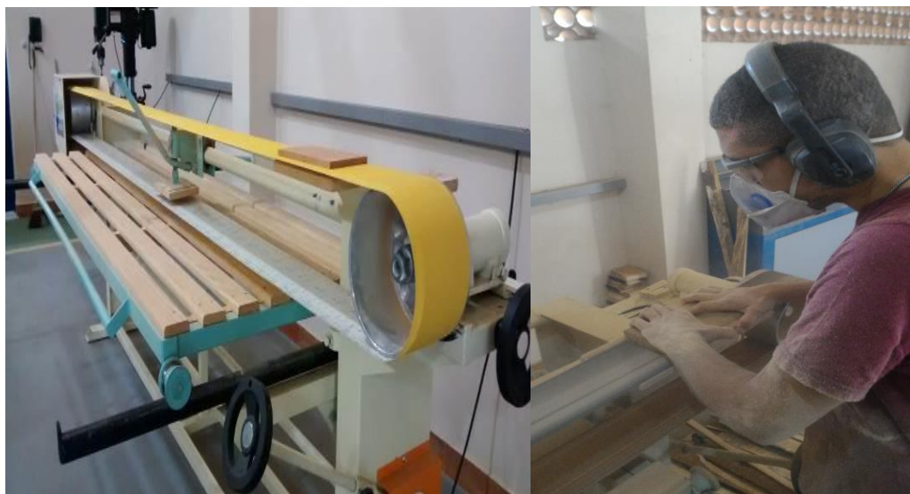
Figura 10- Lixadeira de cinta Possamai PXA-7200 e processo de lixamento da peça.
