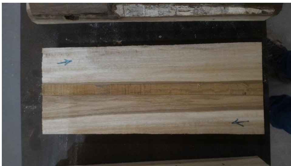
Figura 9- Amostra com o aplainamento já executado, setas indicando a direção do corte (Concordante e discordante).
