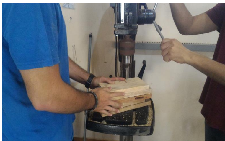
Figura 13- Realização do teste de furação, utilizando a broca helicoidal de 8mm na amostra de Cordia trichotoma .
