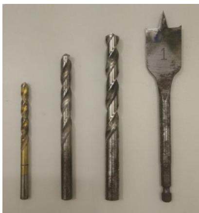
Figura 12- Brocas utilizadas no teste de furação, da esquerda para direita as brocas helicoidais de 6, 8 e 12 mm e a broca chata de 26 mm.
