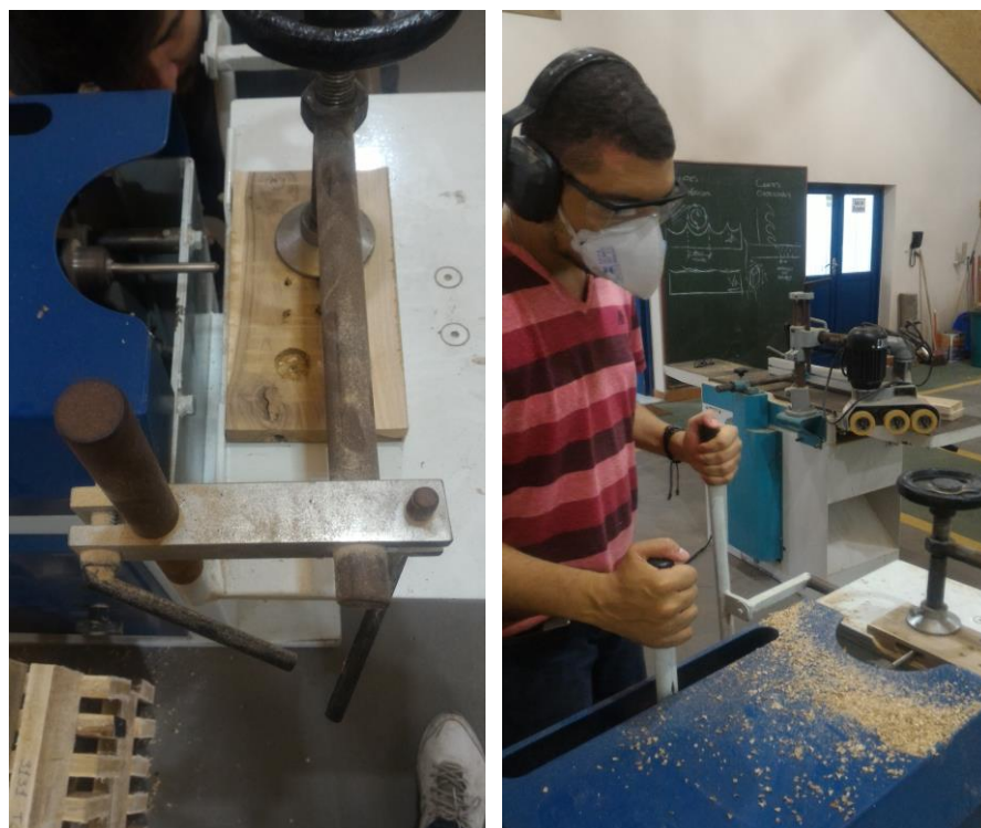
Figura 15- Furadeira horizontal RAIMANN e operação de rasgo lateral no corpo de prova de Cordia trichotoma .
