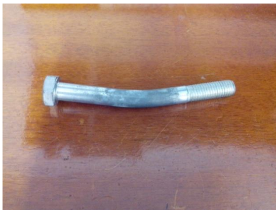
Figura 19. Parafuso deformado após ensaio de resistência da ligação
