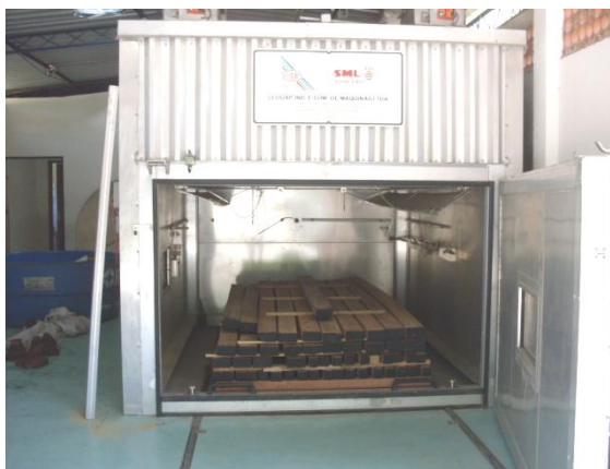
Figura 2. Secagem da madeira em estufa no Laboratório de Física e Secagem da Madeira, UFRRJ
