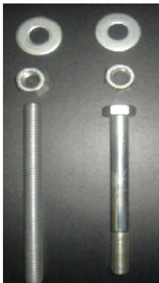
Figura 6. Exemplo de barra rosqueada, parafuso, porcas e arruelas utilizadas na confecção dos corpos-de-prova.
