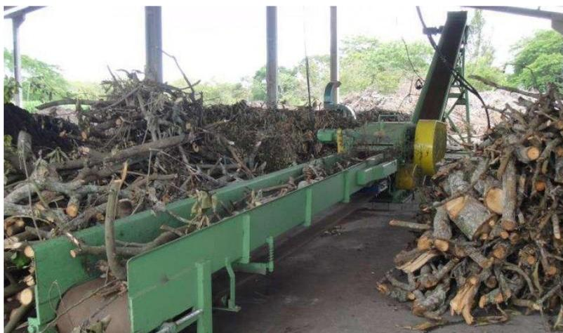
Figura 4: Processo de trituração dos resíduos utilizando picador.
