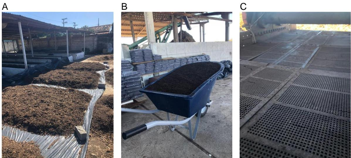
Figura 8: Composto em processo de secagem (A); equipamento utilizado para mensuração do composto resultante (B); peneira de malha de 3mm utilizado para classificação do composto (C).
