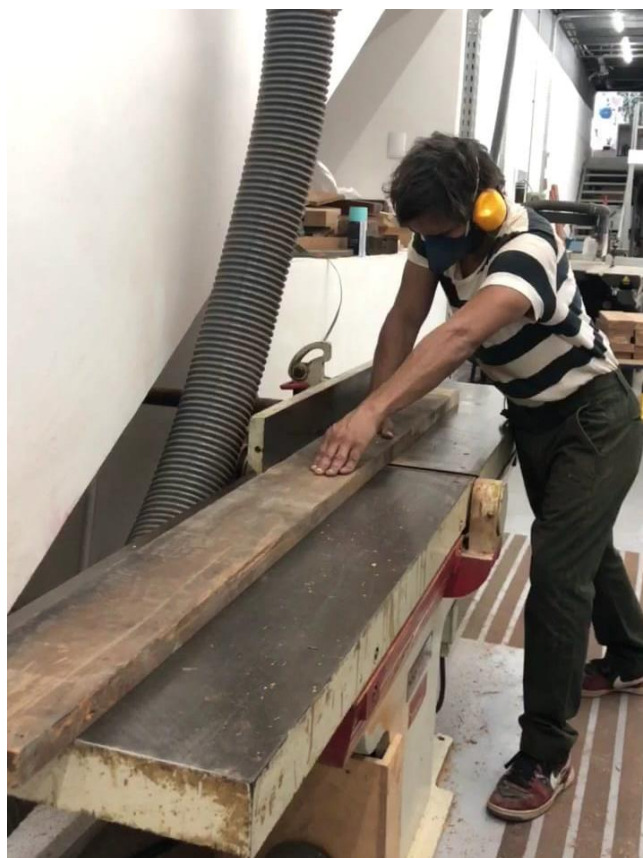
Figura 4 – Desempeno das peças de madeira visando obter material para produção do produto final. Fonte: Danniel Tostes (2019)
