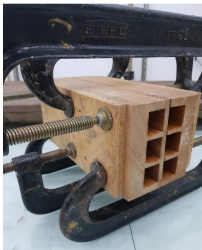
Figura 11 – Tijolos prensados: uso de compensados para não danificar a peça. Fonte: Danniell Tostes (2019)
