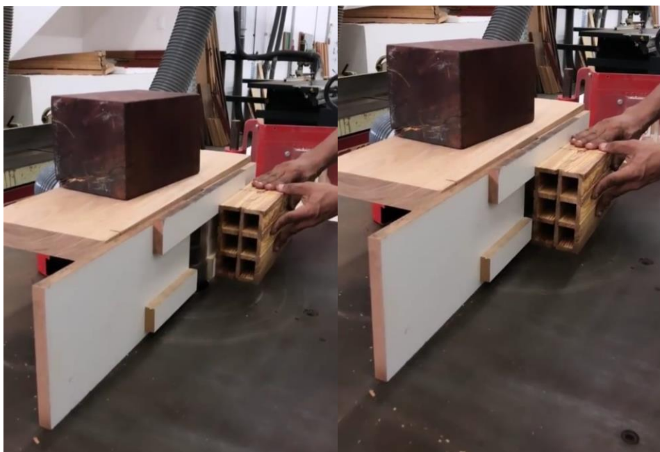
Figura 12 – Frisos sendo feitos na tupia. Fonte: Danniel Tostes (2019)
