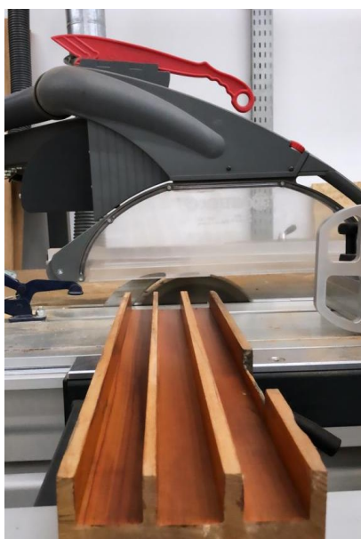
Figura 9–Peça com os canais feitos pronta para ser cortada ao meio. Fonte: Daniel Tostes (2019)
