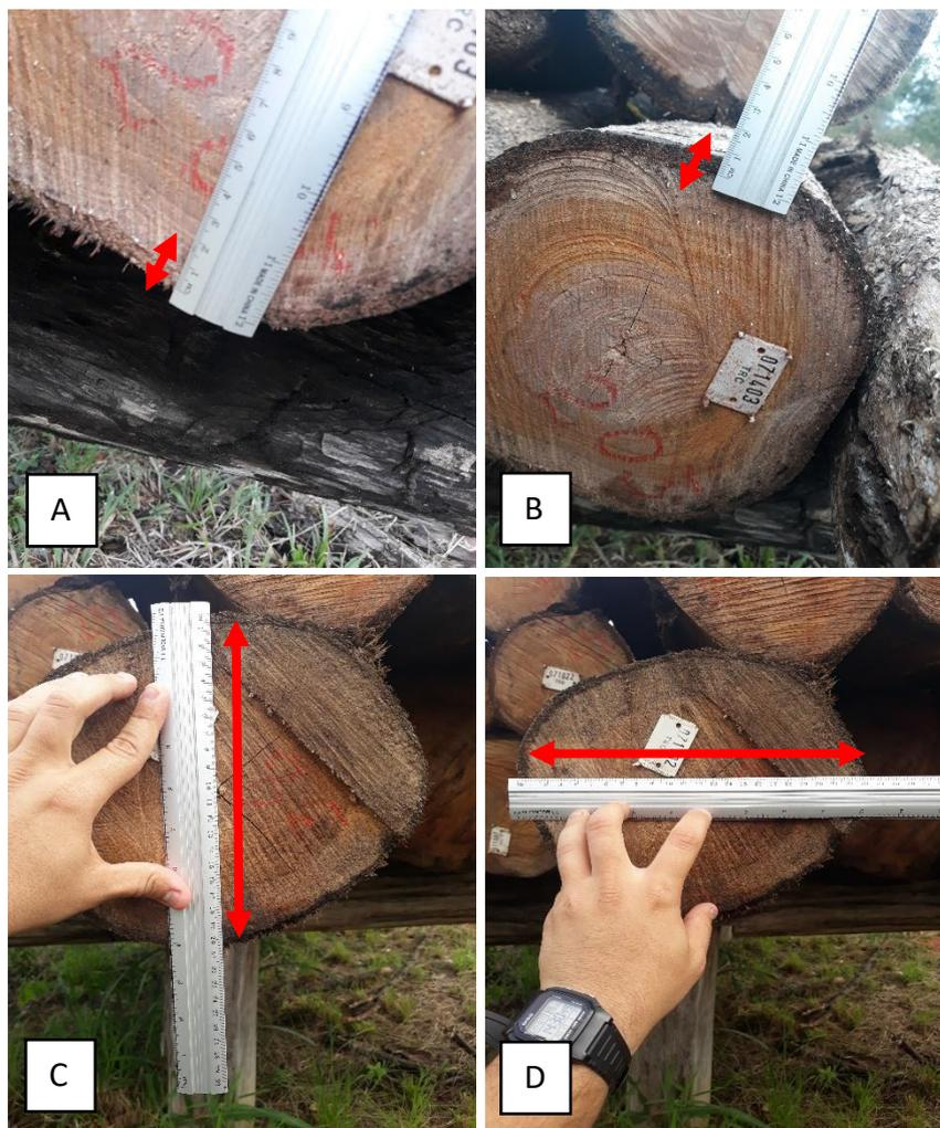
**Figura 2:** (A) distância (x), (B) distância (x'), (C) distância eixo (y) e (D) distância eixo(x)
