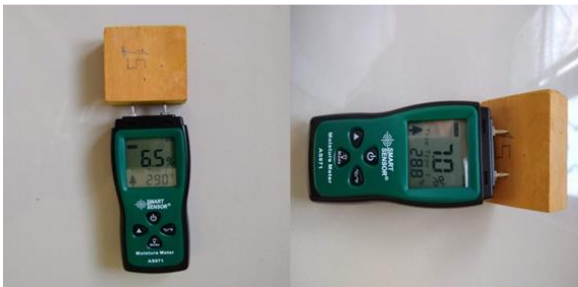
Figura 8: Aparelho medidor de umidade Smart Sensor, mensurando o corpo de prova.
