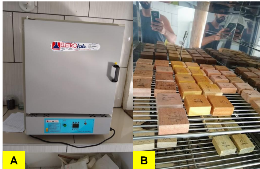
Figura 7: Estufa (A) e corpos de prova (B) mantidos à temperatura de 103 \pm 2^\circ\text{C} .
