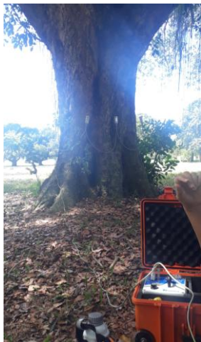
Figura 18. Uso do tomógrafo de impulso, com os sensores instalados no caule.
