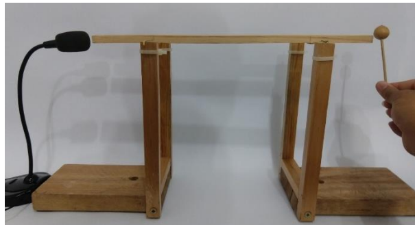
Figura 7. Corpo de prova de Pinus sendo ensaiado pelo método de vibração longitudinal
