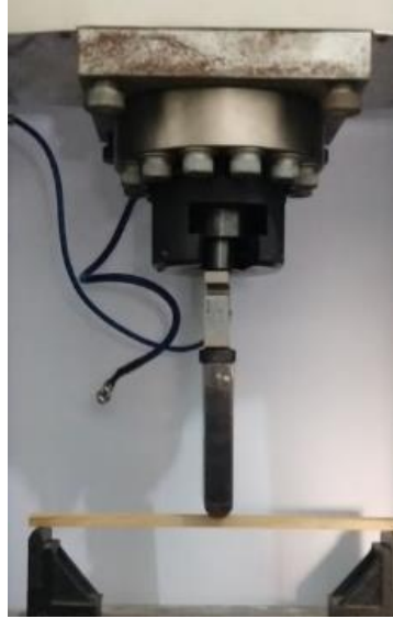
Figura 9. Ensaio de flexão em máquina de ensaios universal mecânica.
