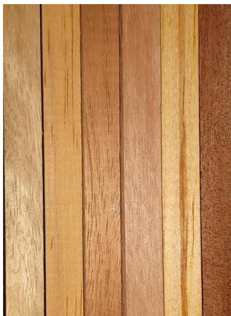
Figura 4. Corpos de prova, da esquerda para direita Corymbia citriodora , Pinus sp. , Khaya ivorensis de baixa densidade, Eucalyptus paniculata , Pinus caribaea e Khaya ivorensis de alta densidade.
