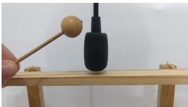
Figura 6. Corpo de prova de Pinus suspenso por elastômeros sendo ensaiado pelo método de vibração transversal
