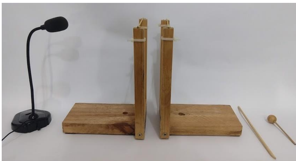
Figura 3. Microfone, suportes e martelletes constituintes do dispositivo para ensaios vibracionais.
