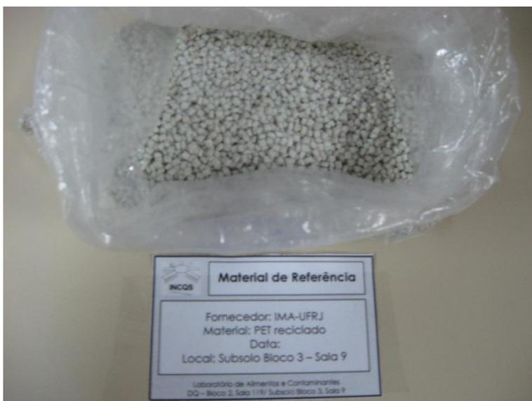
**Figura 18.** *Pellets* de resina reciclada
