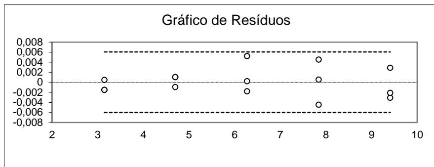
**Figura 69.** Gráfico exploratório dos resíduos da regressão da curva analítica de acetaldeído em ácido acético a 3%
