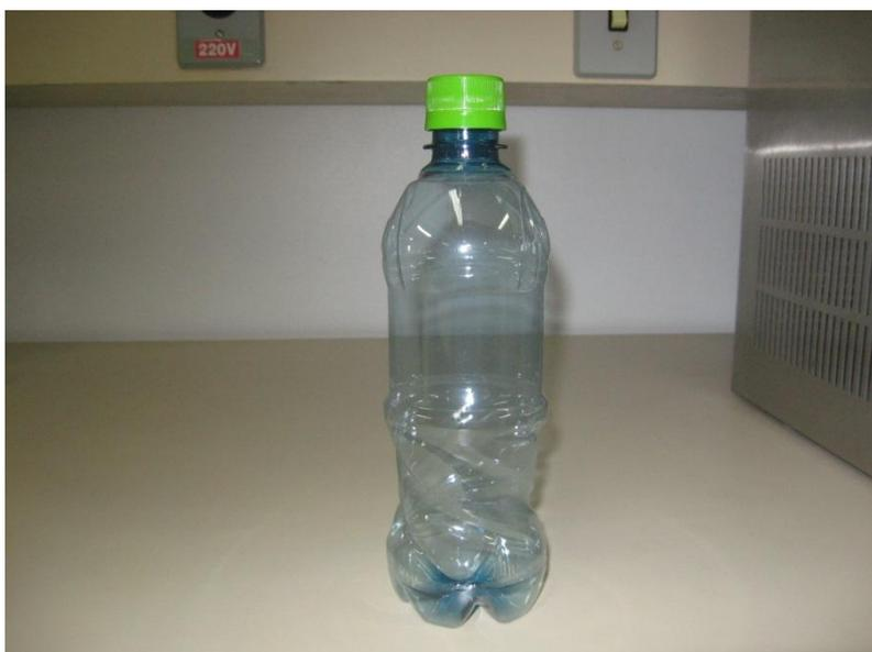
**Figura 21.** Garrafa PET de água mineral, com resina 100% reciclada, e com tampa, de 500 mL.
