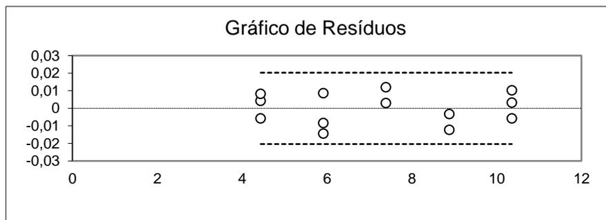
**Figura 68.** Gráfico exploratório dos resíduos da regressão da curva analítica de acetaldeído em água
