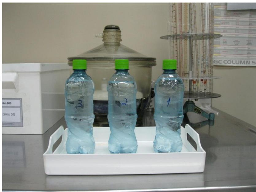
**Figura 24.** Amostras de garrafas PET-PCR cheias com simulantes, usadas nos ensaios de migração.
