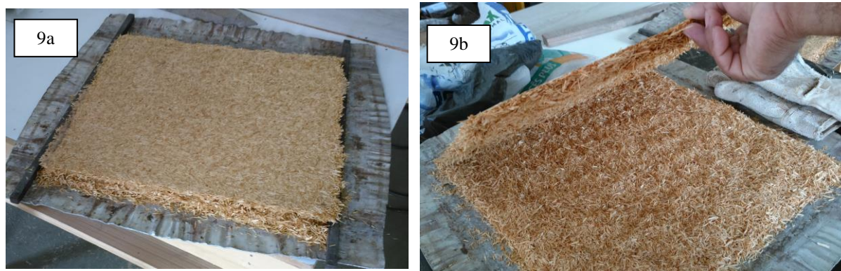
Figuras 9a e 9b. Painéis não consolidados após serem produzidos com UF e LS, na proporção 40:60, com tempo de 7 minutos
