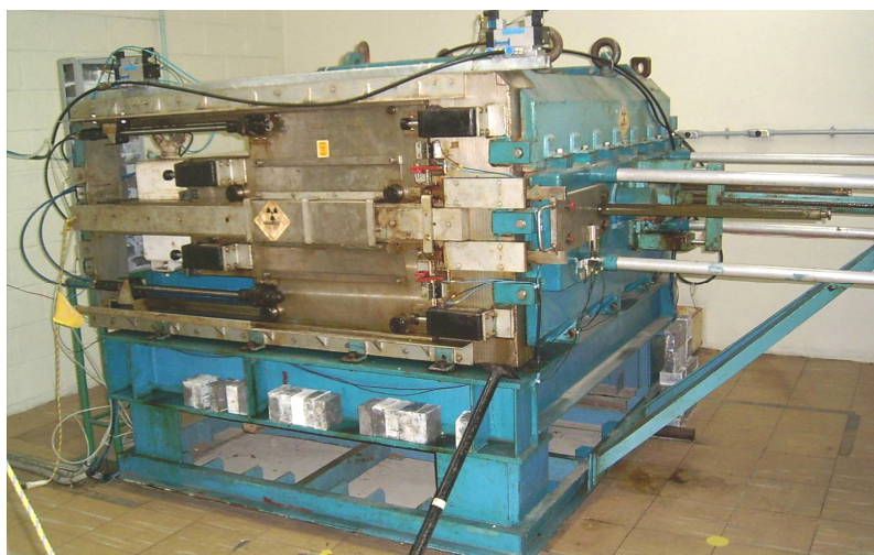
Figura 12. Irradiador Gama de Pesquisa do Centro Tecnológico do Exército – Cortesia da Seção de Defesa Nuclear, Divisão DQBN (Defesa Química Biológica e Nuclear) do Centro Tecnológico do Exército (CTEx).
