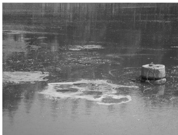
Figura 13 – Câmara flutuante para amostragem dos gases dentro da lagoa.
