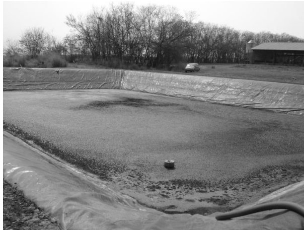
Figura 20 – Lagoa de estabilização de DLS sendo esvaziada com a câmara posicionada para amostragem.
