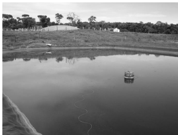
Figura 21 – Lagoa de estabilização de DLS em granja de produção de leitões com a câmara posicionada.
