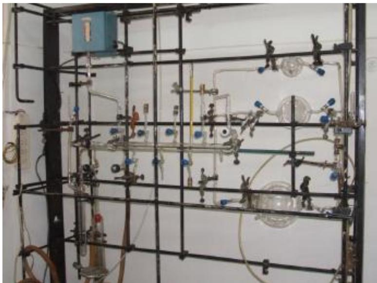
**Figura 6-** Sistema de inserção dos reagentes na câmara de reação.
