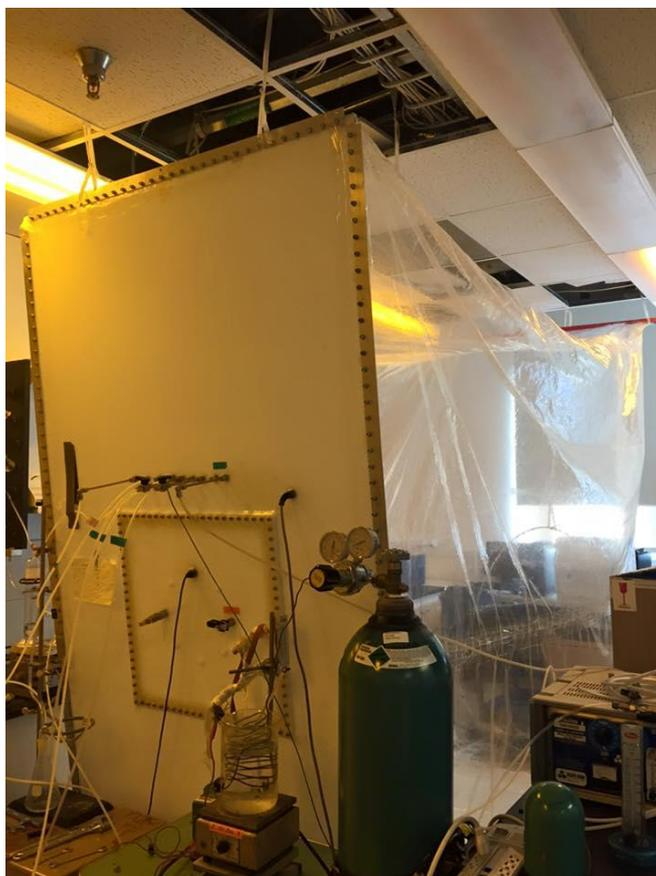
**Figura 11** - Câmara de reação de 10.000L.
