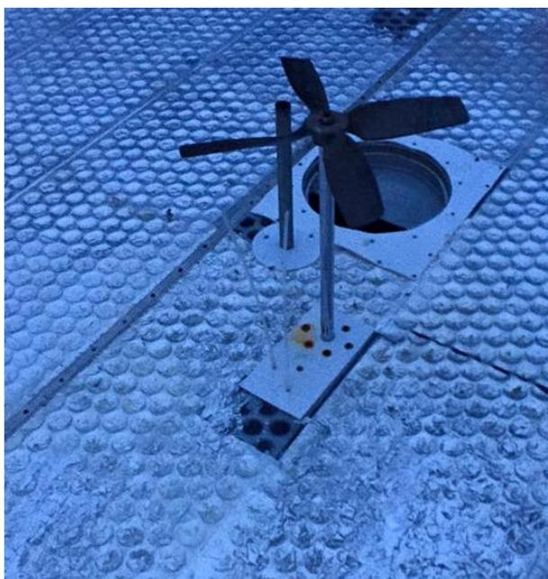
**Figura 8** - Ventilador localizado no interior da câmara de reação.
