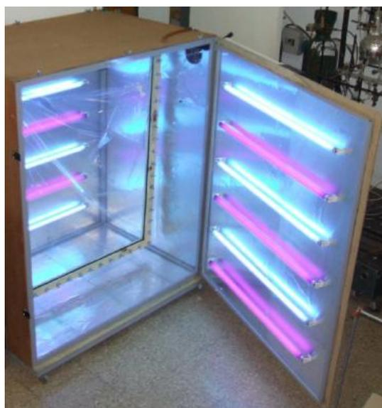
**Figura 4** - Câmara de reação de Teflon (200L).
