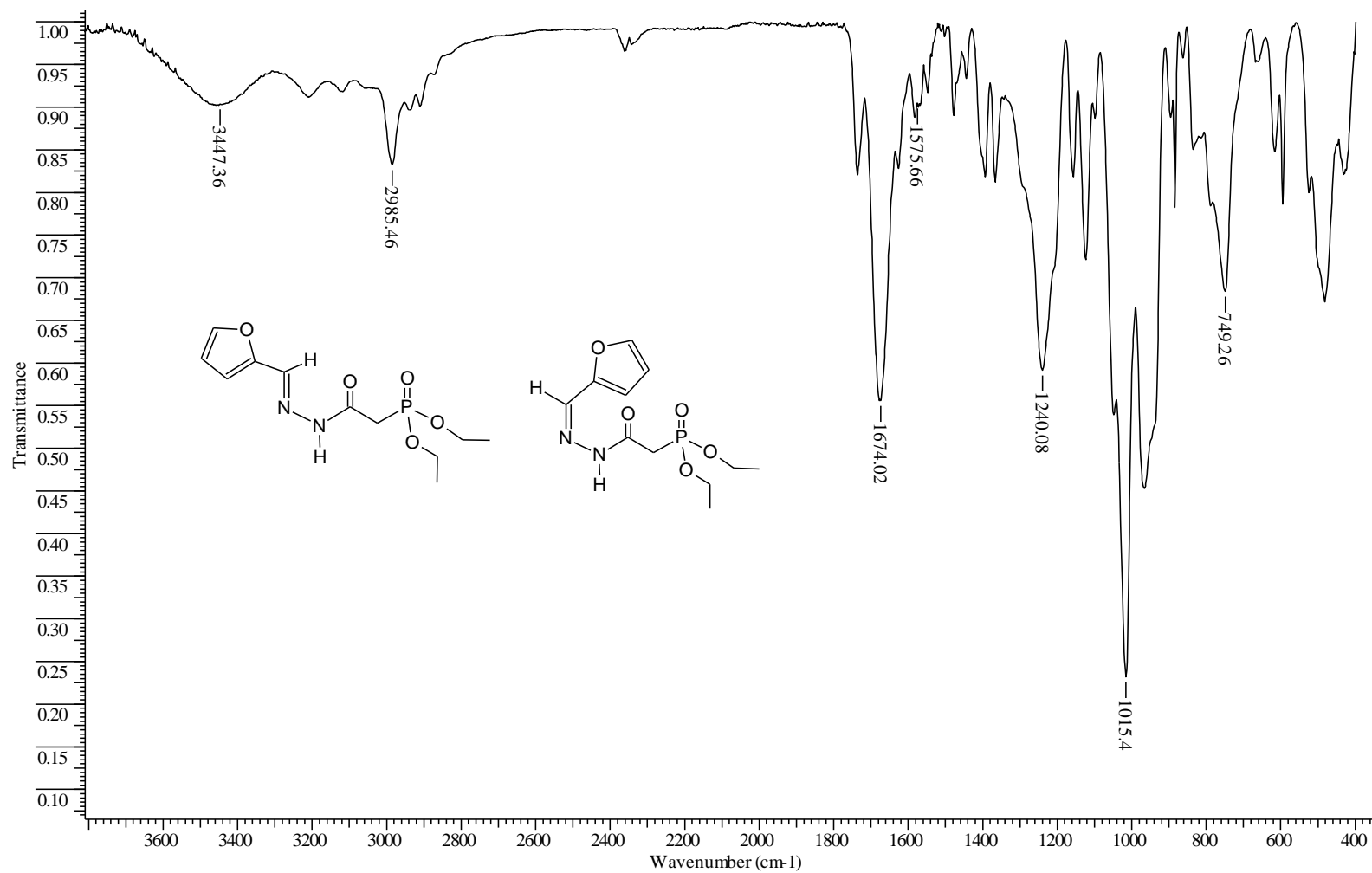
Figura 84 - Espectro de IV (Célula de NaCl) - [2( E/Z )-2-(2-furilmetileno)hidrazinil]-2-oxoetilfosfonato de dietila (9).
