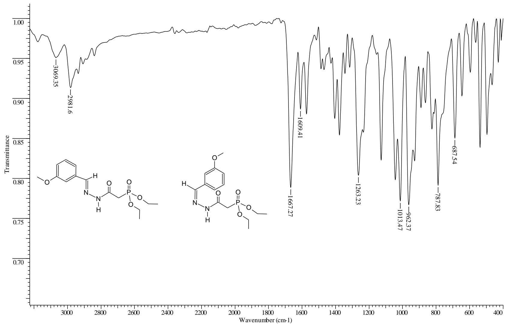
Figura 37 - Espectro de IV (Célula de NaCl) - [2( E/Z )-2-(3-metoxibenzilideno)hidrazinil]-2-oxoetilfosfonato de dietila (1).
