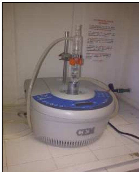
Figura 32. Reator de micro-ondas utilizado para síntese orgânica em laboratório.
