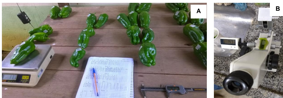
Figura 8 – Avaliações dos frutos de pimentão, quanto ao comprimento médio, diâmetro basal, peso médio, contagem de frutos comerciais (A) e Análise de verificação de sólidos solúveis totais com auxílio de refratômetro analógico de mesa (B).
