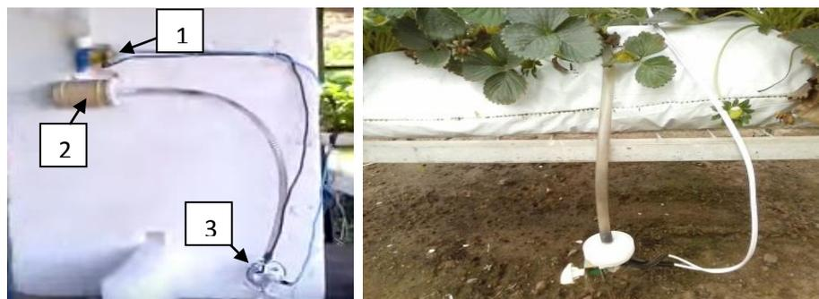
**Figura 6.** À esquerda, esquema do acionador automático de baixo custo (1- válvula solenoide; 2- filtro de cerâmica e 3-pressostato). Fonte Dione Galvão da Silva. À direita, acionador automático instalado no *slab*. São Vicente do Sul/RS, 2014.
