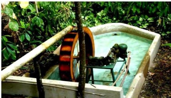
**Figura 34:** Elevação por roda d'água – duas bombas sapo (2011)
