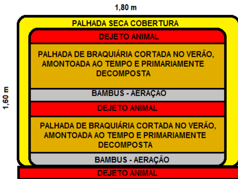
Figura 12 – Desenho demonstrativo das camadas para montagem da pilha de compostagem de fabricação caseira.
