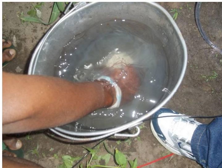
Figura 7: A figura ilustra a retirada do ar de dentro da vela
