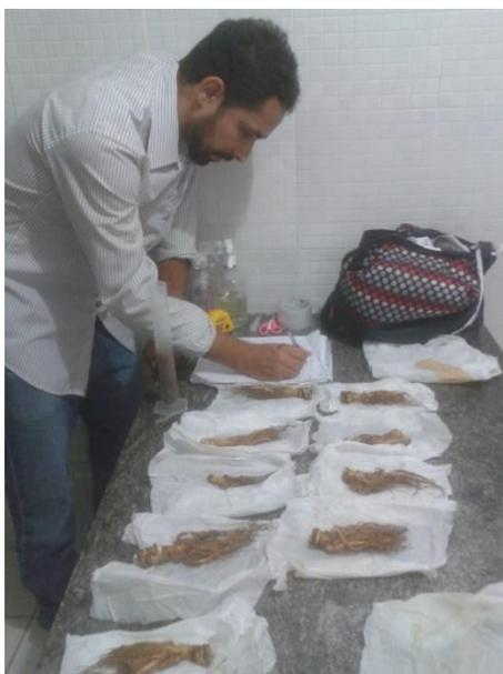
**Figura 8:** Medição do volume de raiz com auxílio de uma proveta.
