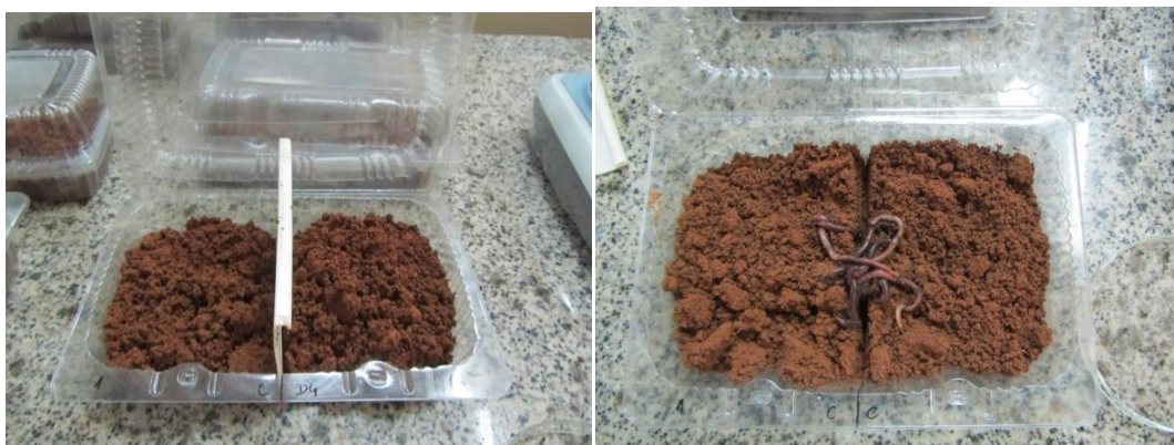
Figura 3. Montagem do ensaio de fuga.
