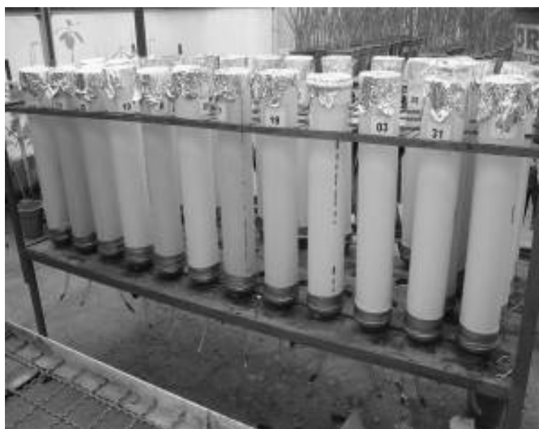
Figura 1. Colunas de solo, em PVC, utilizadas no ensaio de lixiviação.
