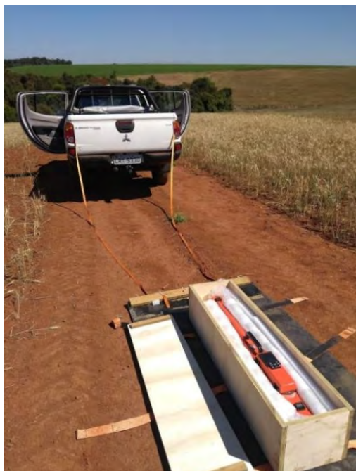
Figura 3. EM38-MK2 acoplado à caminhonete. Fonte: Hugo Machado Rodrigues.
