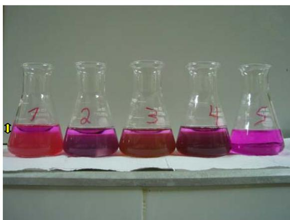
**Figura 20:** Formação de precipitados durante a titulação com NaOH do extrato de digestão, com HCl na determinação do PN (1= HSPó; 2, 3 e 4 = Esc1; 5= Ccal.).
