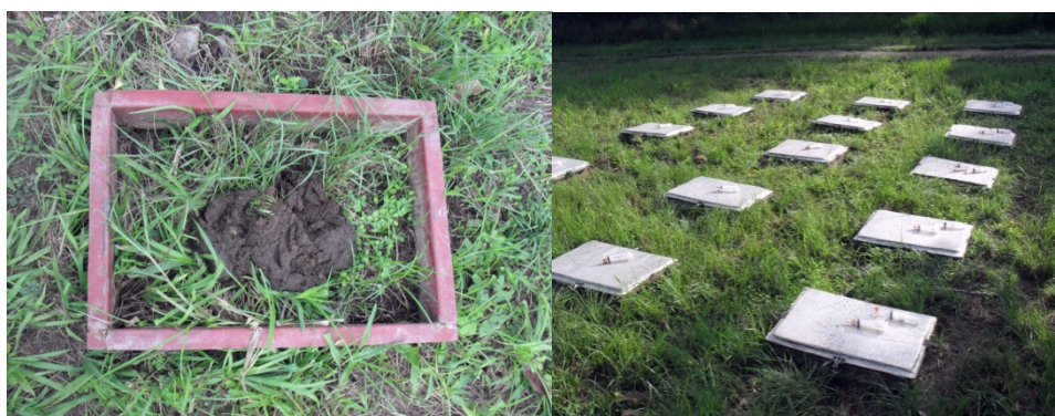
Figura 2 À esquerda: unidade experimental mostrando a base da câmara estática, onde foi colocada centralmente a excreta de bovinos. Direita: visão parcial do experimento; em destaque as câmaras com as tampas acopladas durante o período de incubação.
