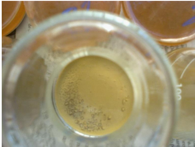
Figura 38. Nódulo de calcita na amostra após o ataque ácido na determinação do carbonato de cálcio.
