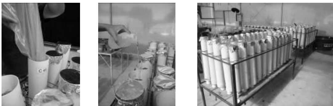
Figura 6. Adição da mistura de solo e resíduo, adição de água e colunas dispostas em bancadas.
