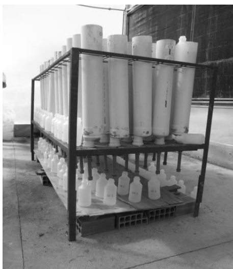
Figura 8. Coleta dos extratos lixiviados utilizando recipientes plásticos.
