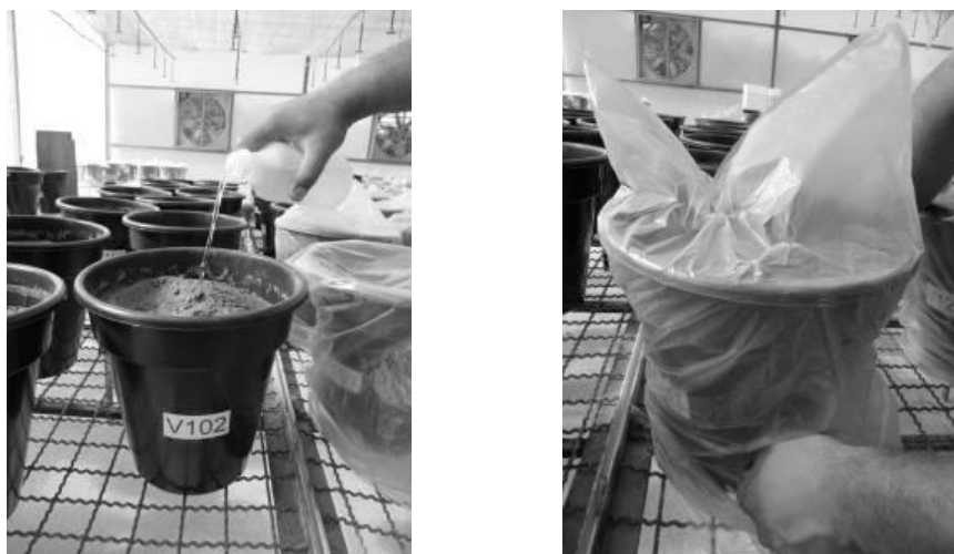
Figura 3. Incubação do solo com resíduo a 70% da capacidade de campo.
