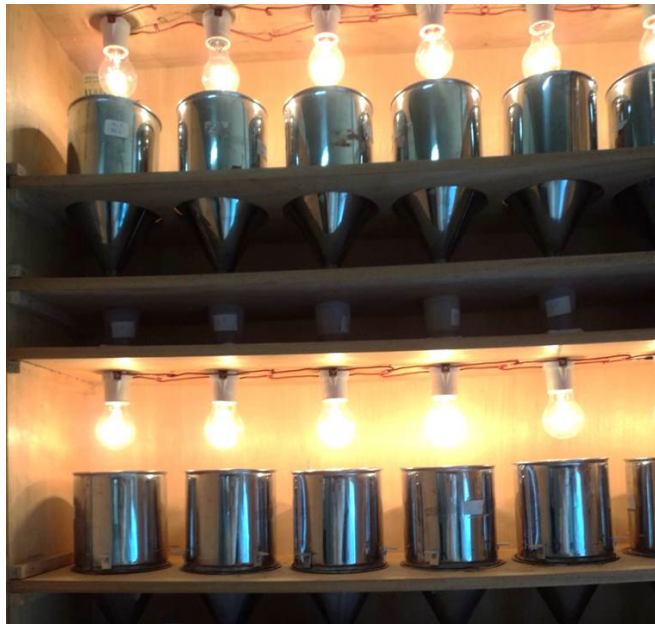
Figura 6. Extrator Berlese - Tullgren do Laboratório de Fauna do Solo da Embrapa Agrobiologia utilizado no estudo.
