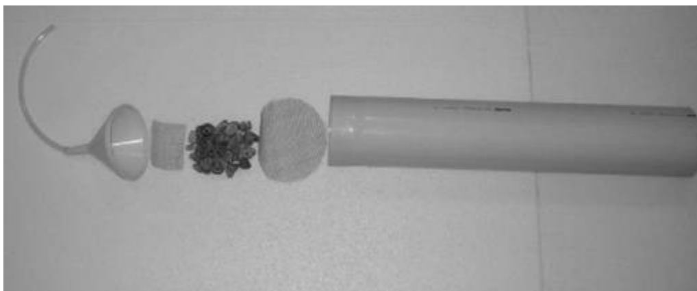
Figura 5. Componentes que constituem as colunas de lixiviação, antes da montagem.
