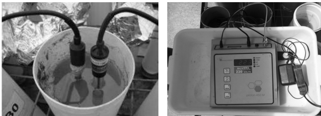
Figura 7. Determinação do potencial redox (Eh) e do pH nas colunas de lixiviação.
