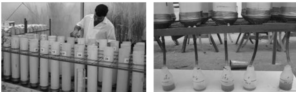
Figura 8. Adição da água e coleta dos extratos lixiviados nas colunas de solo utilizando recipientes plásticos.
