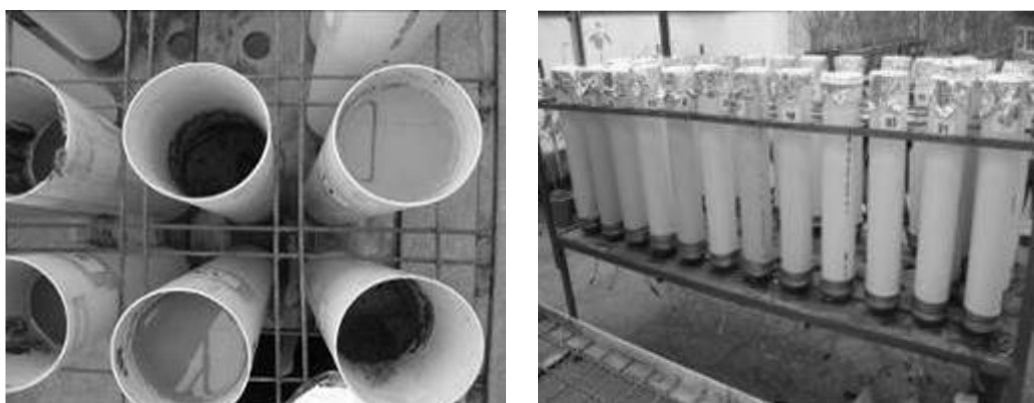
Figura 6. Colunas de lixiviação (PVC) dispostas nas bancadas metálicas durante a condução do experimento.
