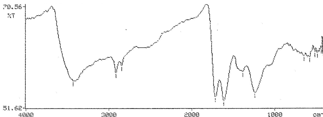
Figura 24. Espectro de transmitância (%T) no infravermelho de ácidos húmicos purificados. Horizonte Bh espódico (Espodossolo).
