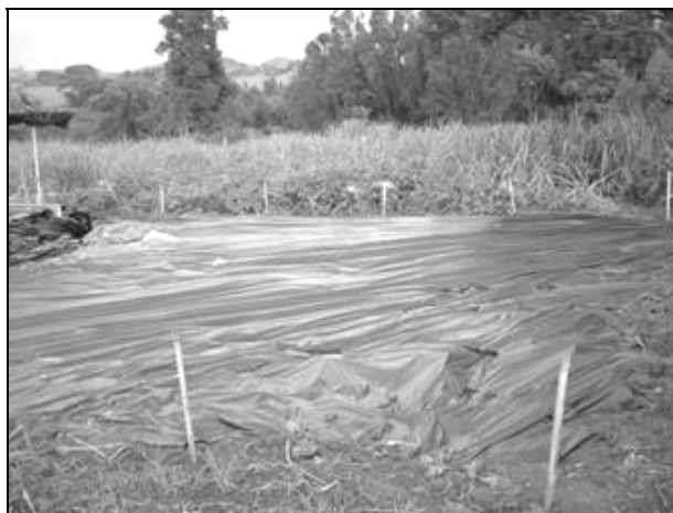
Figura 13. Cobertura da área com lona para minimizar interferências de chuvas naturais depois do início do experimento.
