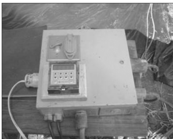
Figura 3. Dispositivo eletrônico ou painel responsável pelo controle do tempo/ciclo do simulador.
