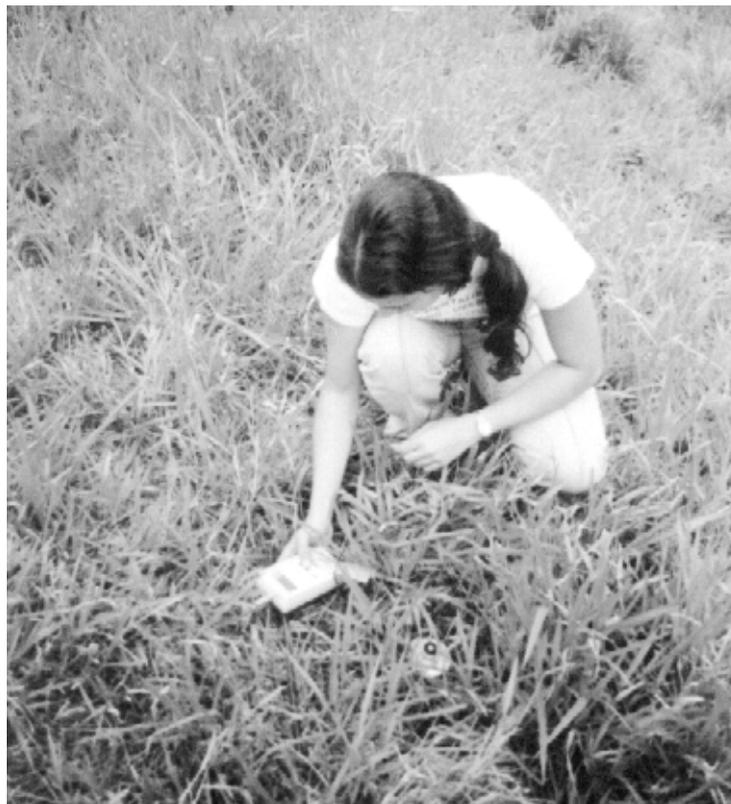
**Figura 4.** Medição de radiação fotossinteticamente ativa (RFA) ao nível do solo.
