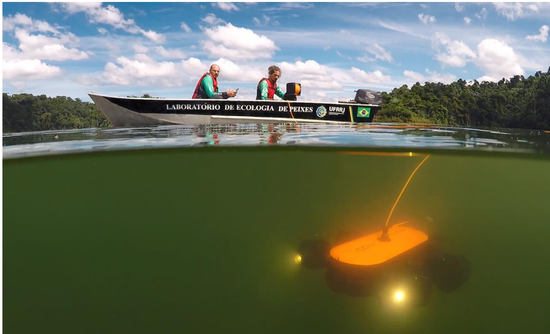
Figura 4. Veículo operado remotamente modelo Genneino T1 sendo operado a partir de um barco no Reservatório das Lajes, Estado do Rio de Janeiro, Brasil.
