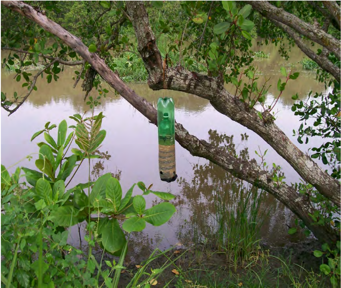
Figura 8: Armadilha confeccionada em recipiente plástico com 35 cm de altura e 15 cm de diâmetro. Na parte inferior, revestida por material plástico preto com quatro aberturas e na parte superior um funil plástico suspensas a uma altura de 1,20 m do solo contendo 100g de isca de peixe (sardinha) em decomposição.
