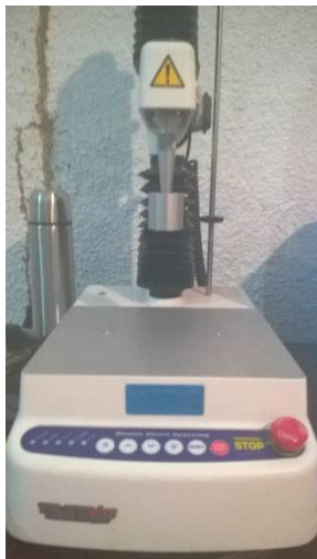
Figura A4 - Texturômetro universal TA.XT2, Stable Micro Systems.
