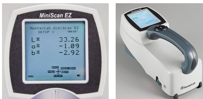
Figura A3 – Colorímetro MiniScan EZ, marca Hunter Lab.]
