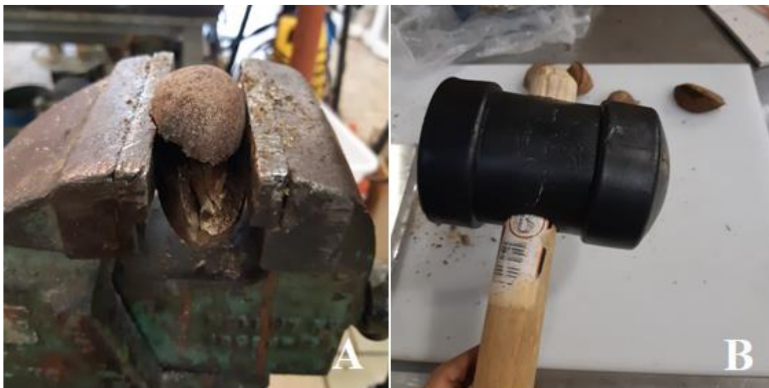
Figura 8: Equipamentos utilizados para abrir as castanhas. A - Torno mecânico. B – Martelo de borracha.
