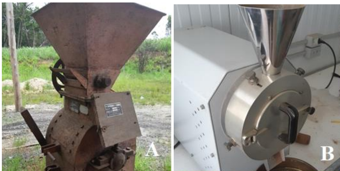
Figura 10: Equipamentos utilizados no processamento de produtos florestais. A - Moinho de Martelo e B – Moinho em Facas.
