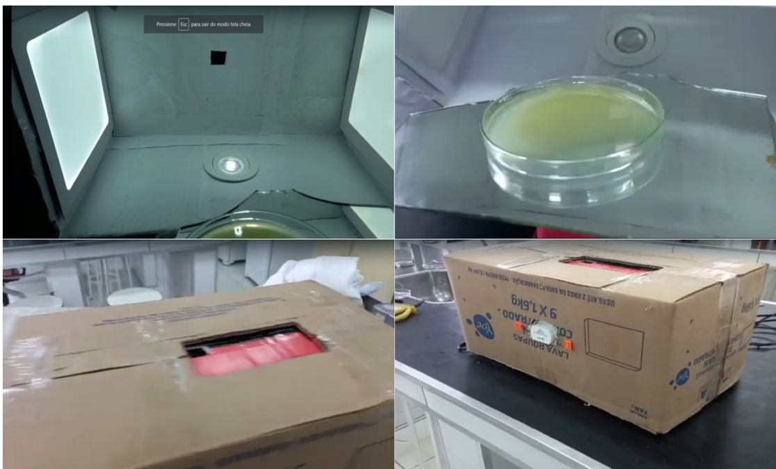
Figura 1: Imagens da caixa de luz para a coleta de dados colorimétricos via (smartphone).
