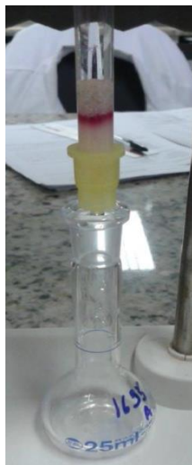
Figura 14. Eluição da fração de fitato com solução de HCl 2,0M.
