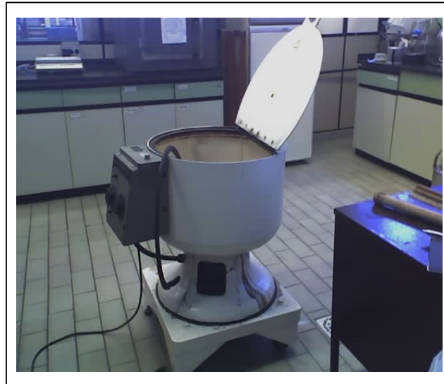
Figura 14: Centrífuga de cestos.
