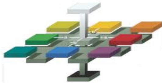
**Figura4.** Escala de cor de Hunter. L\* (eixo vertical): máximo estímulo luminoso; a\* (no eixo horizontal) variação entre a cor vermelha à verde; b\* variação entre o amarelo e o azul.
