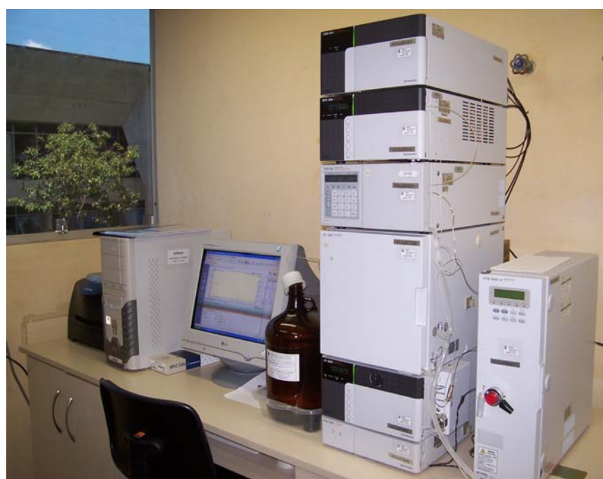
Figura 6. Cromatógrafo utilizado para a determinação do índice de CMP (mg/L)
