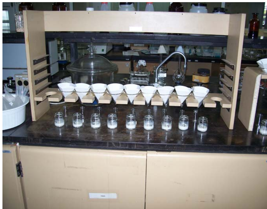
Figura 5. Amostras sendo filtradas após adição de TCA e repouso durante 60 min.
