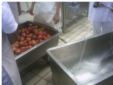
Fotografia 5- Tanque de lavagem das matérias-primas
