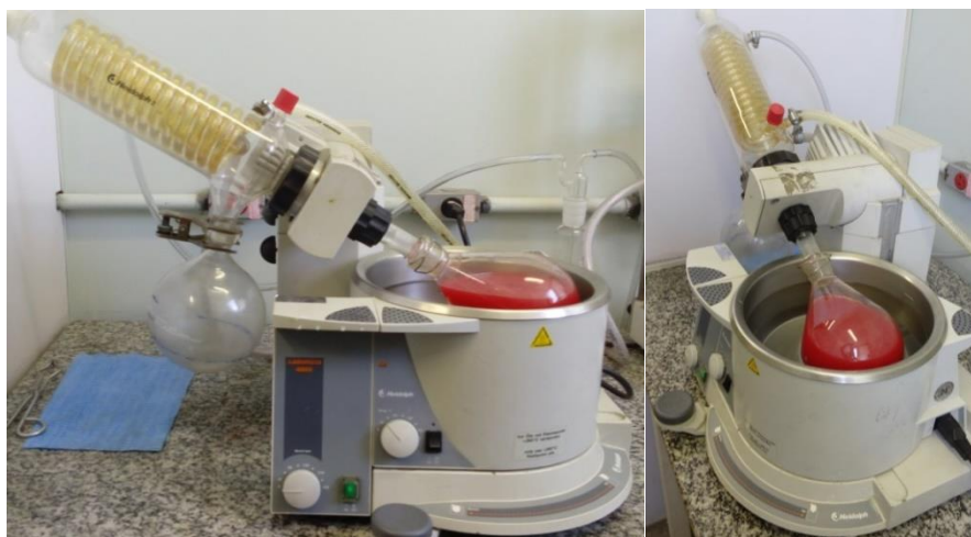
Figura 10. Concentrador com banho térmico acoplado ao vácuo
