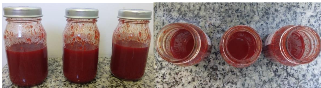
Figura 11. Concentrados obtidos utilizando temperatura de 45 °C, 55 °C e 65 °C, respectivamente, da esquerda para a direita
