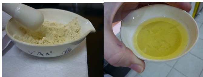
Figura 13: Trituração da amostra com Celite® e adição de acetona.
