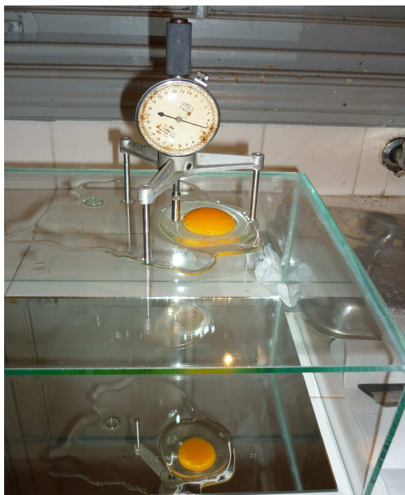
Figura 10: Medição da altura do albúmen denso com micrômetro tripé.
