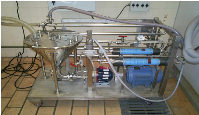
**Figura 10.** Módulo de osmose inversa de configuração espiral.
