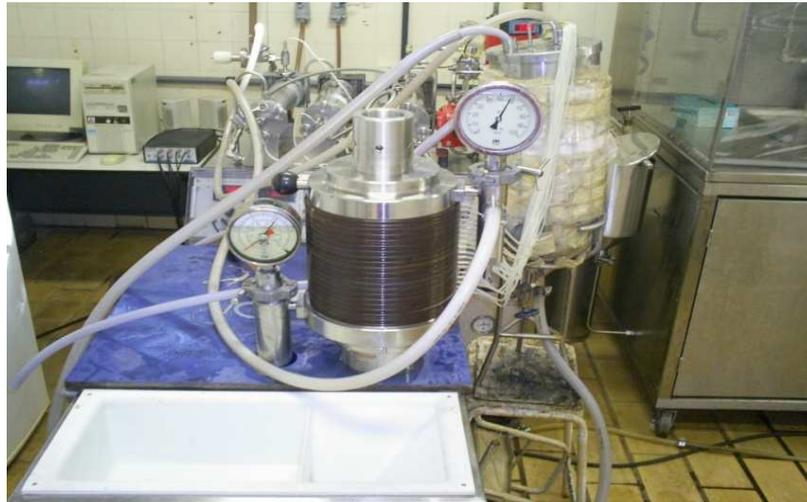
**Figura 12.** Módulo de osmose inversa de configuração quadro e placas.
